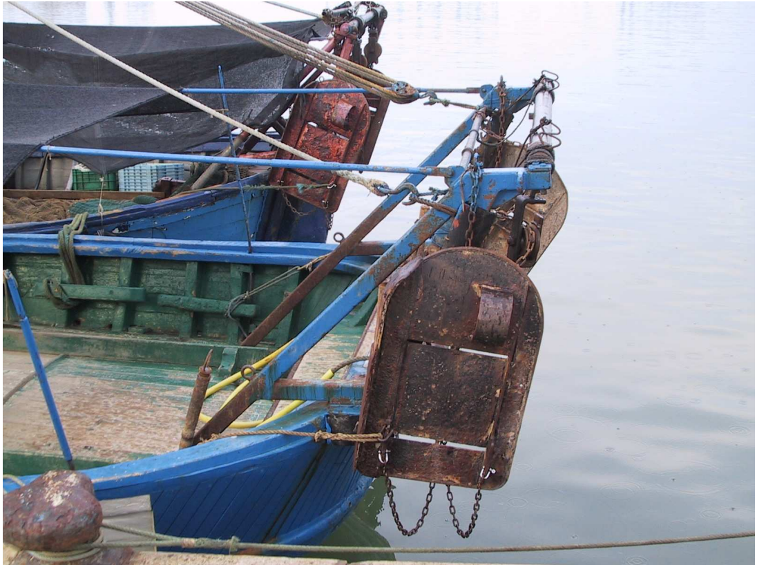
La popa del quillat amb les característiques “portes” de l’arrossegament
