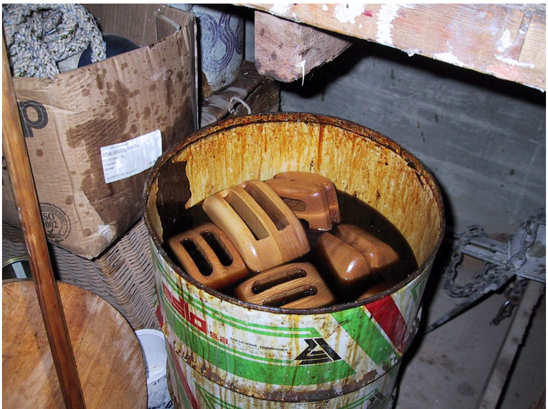
Els bossells i quadernals construïts expressament pel Sant Ramon , en remull amb oli de llinosa per garantir la seva conservació
