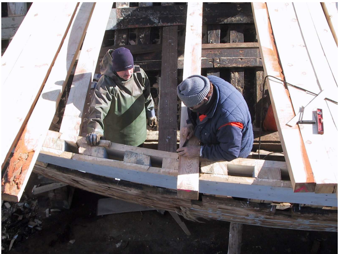
Marcant l'ençaig d'un extrem d'un bao
