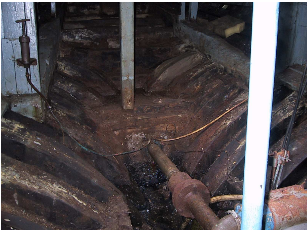
La bocina per on entrava constantment un rajolí d'aigua va ser una de les nostres principals preocupacions
