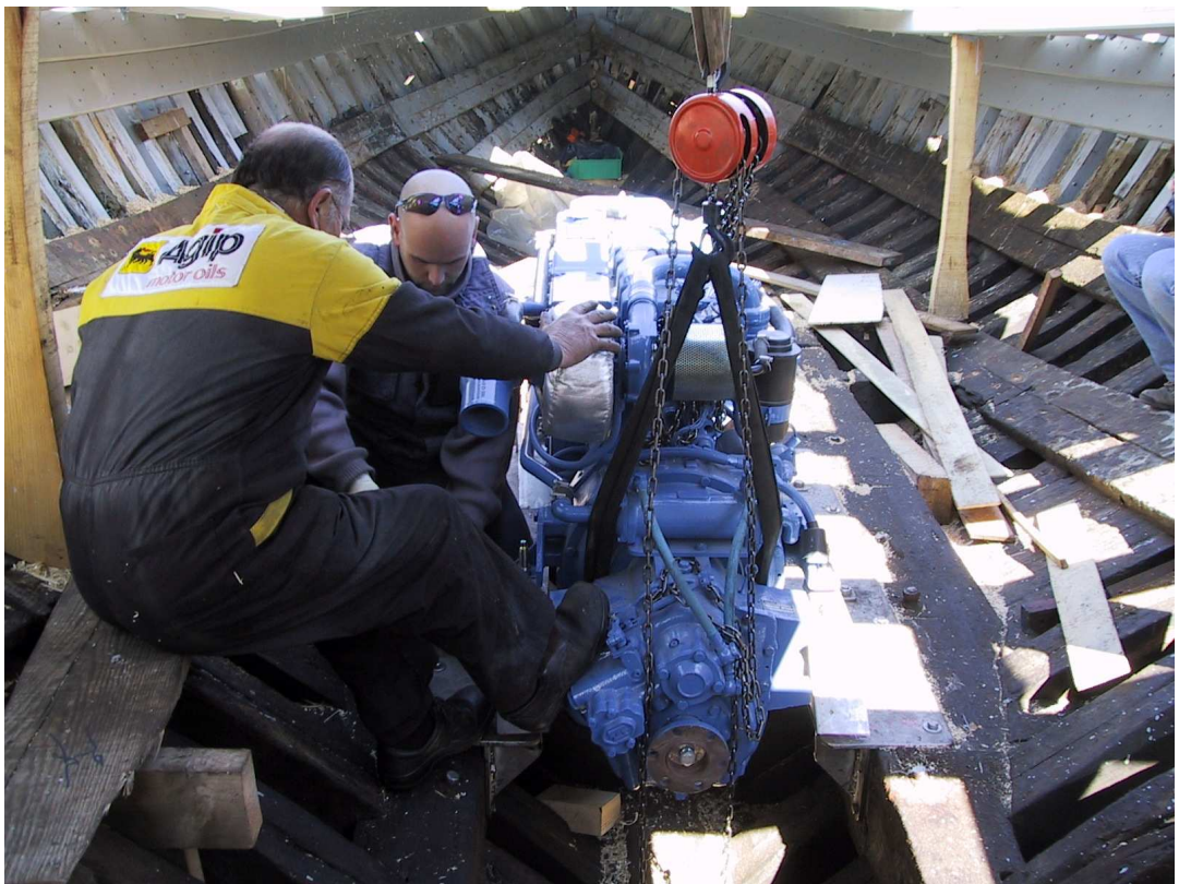
Instal·lació del nou motor Solé diesel de 210 cavalls de potència
