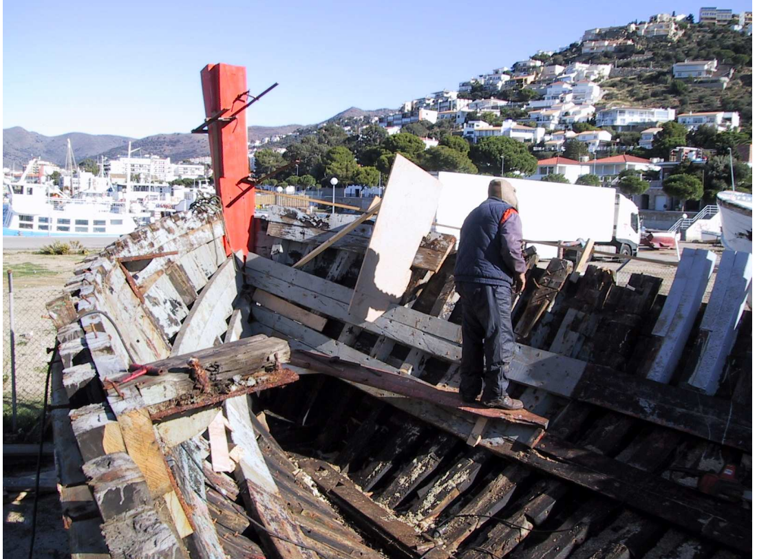
Acabant d'entaliconar el costat d'estribord
