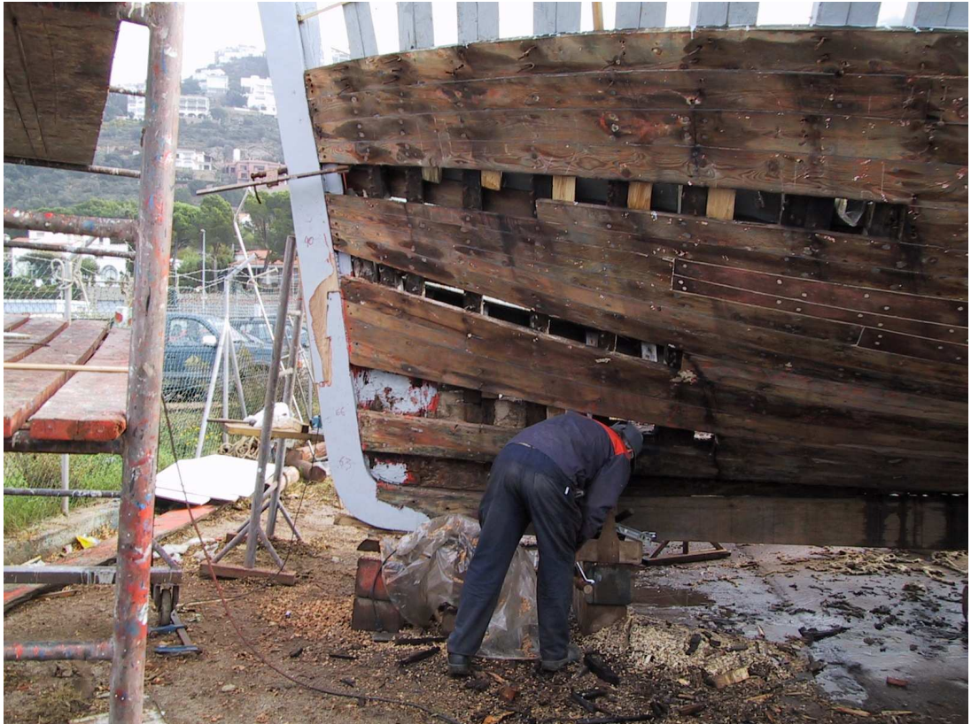
Treballs de rebaixar els costats de la roda i peu de roda
