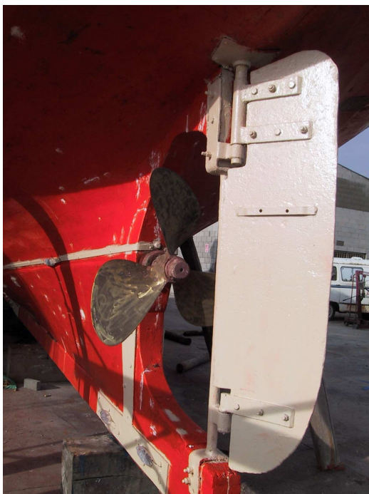
El timó de bronze totalment poit i vista del Sant Ramon per la seva proa
