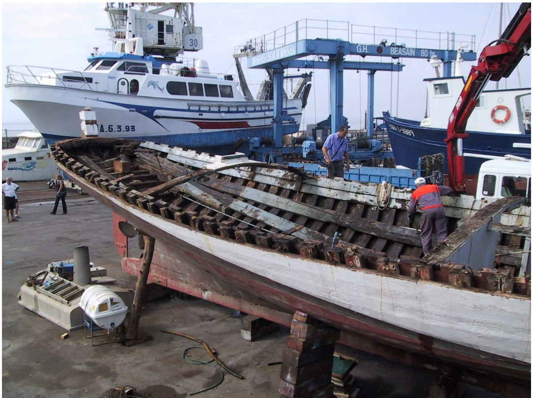
El vaixell, amb tota la oberta desballestada, només presentava uns quants baus com a reforç
