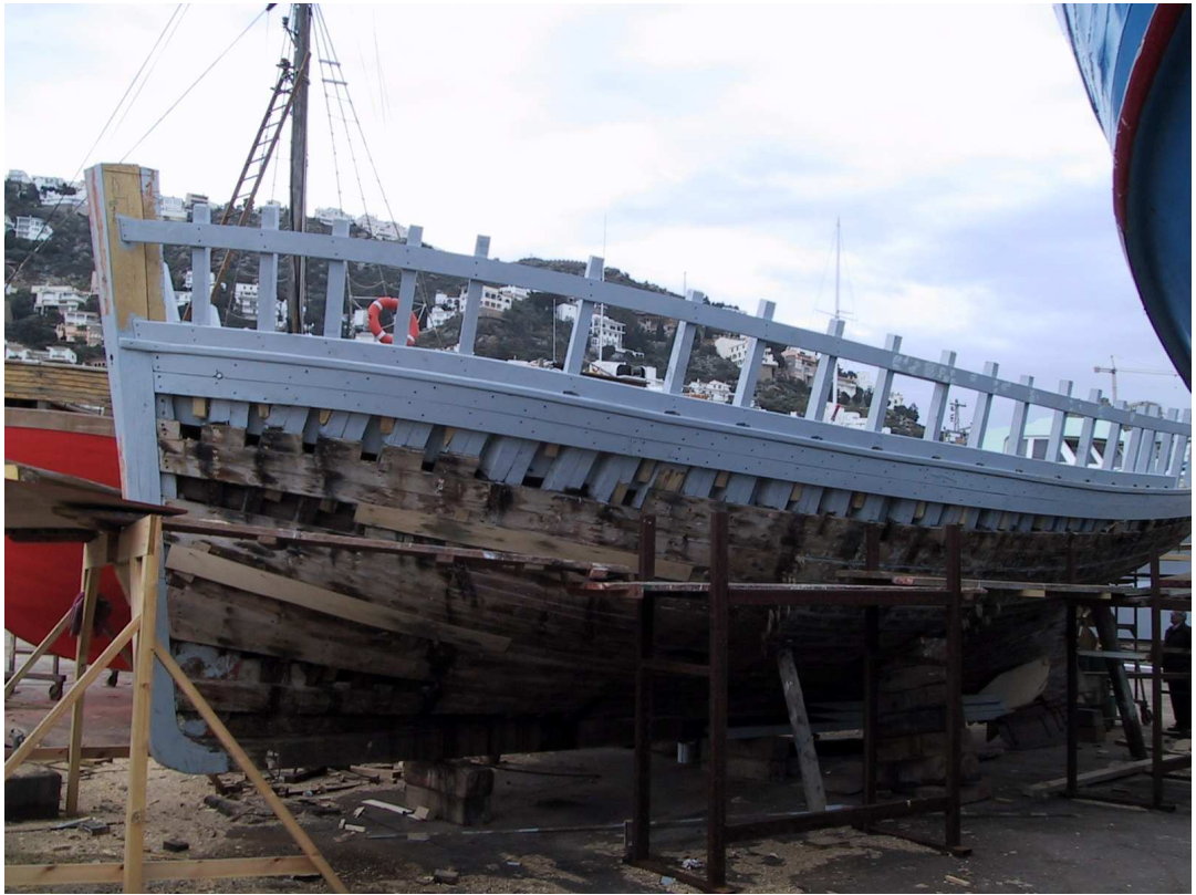
La nova roda, barraganets, cintes i tapa de claus
