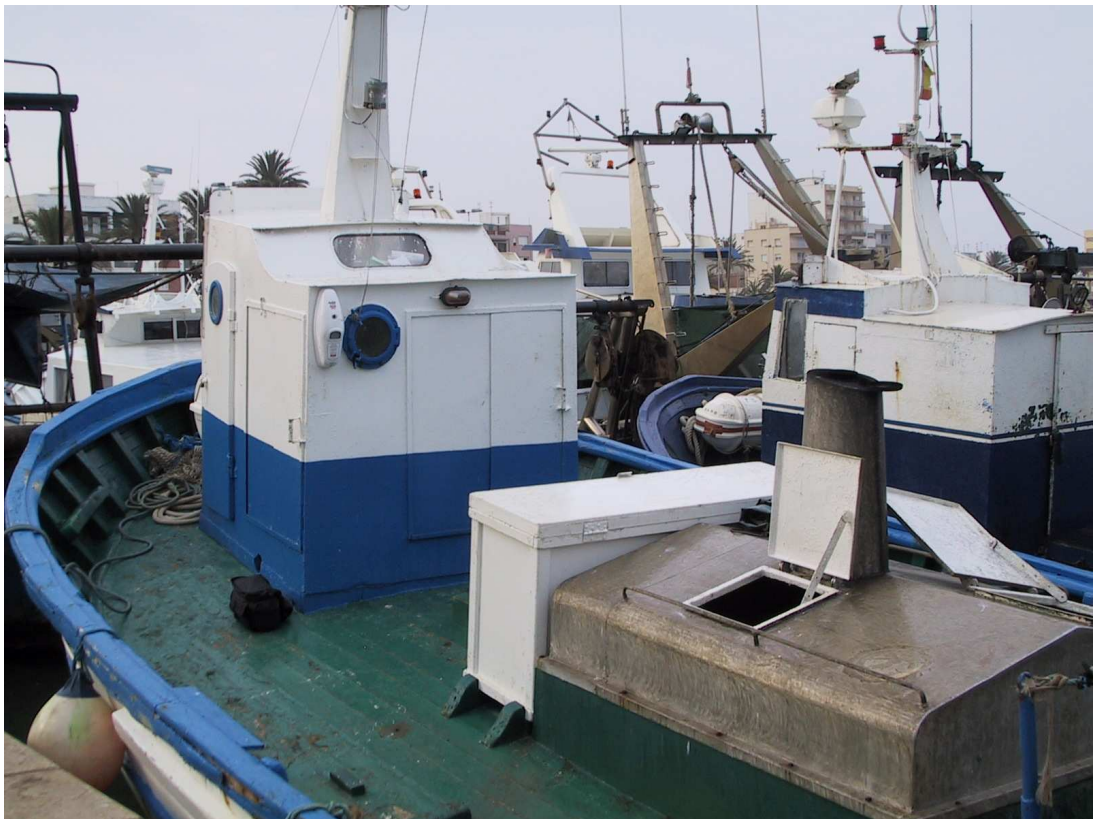
La timonera a proa, la caixa blanca per conservar el gel i la llumbrera, donaven el clàssic aspecte d’una embarcació de pesca a motor
