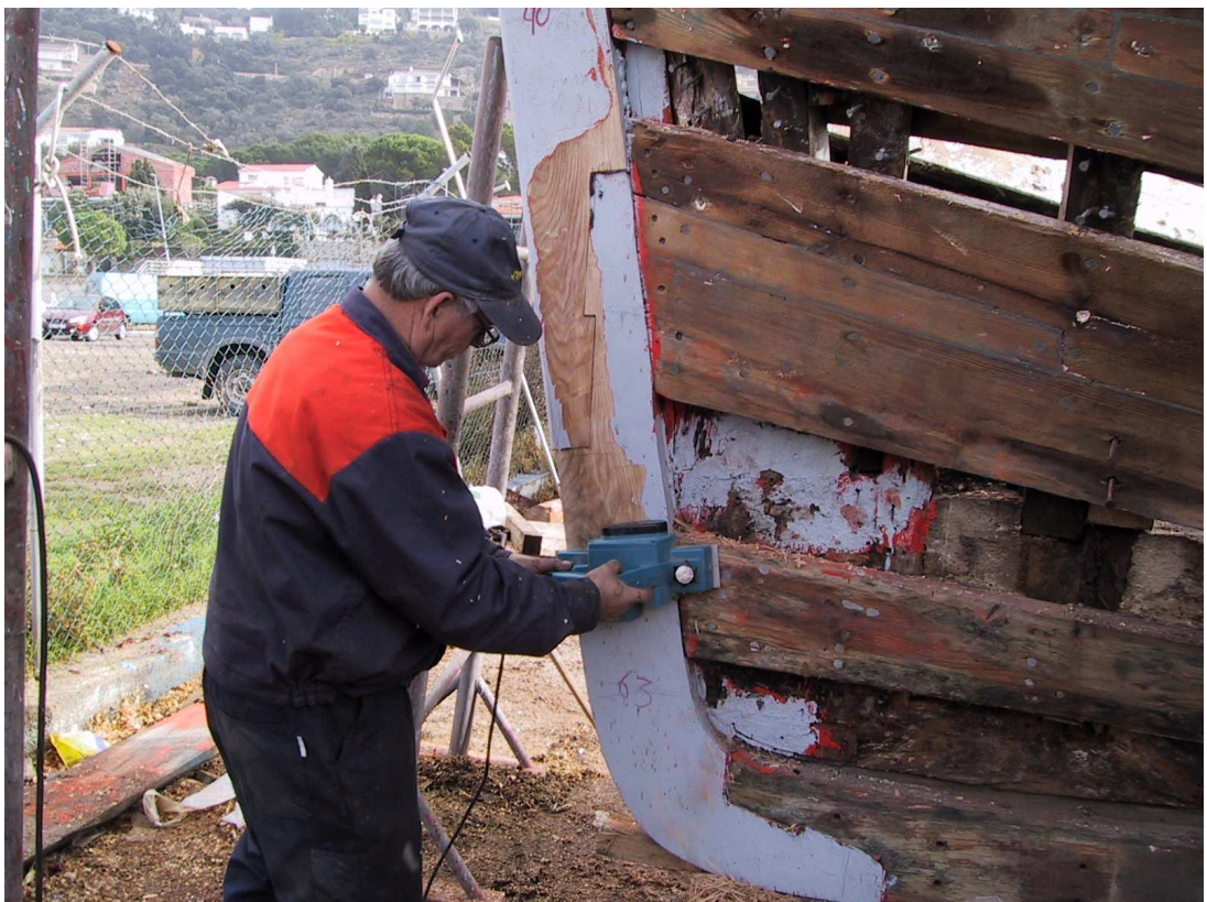
Treballs de rebaixar els costats de la roda i peu de roda
